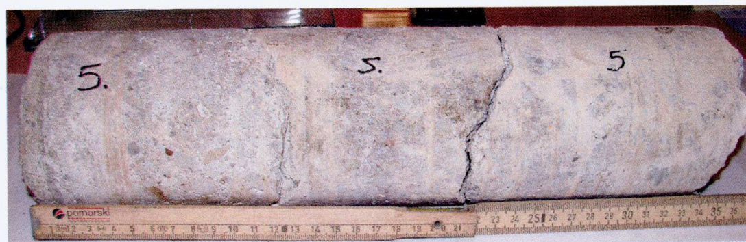
Fot. 23. Próbkę uszkodzoną w trakcie pobierania
